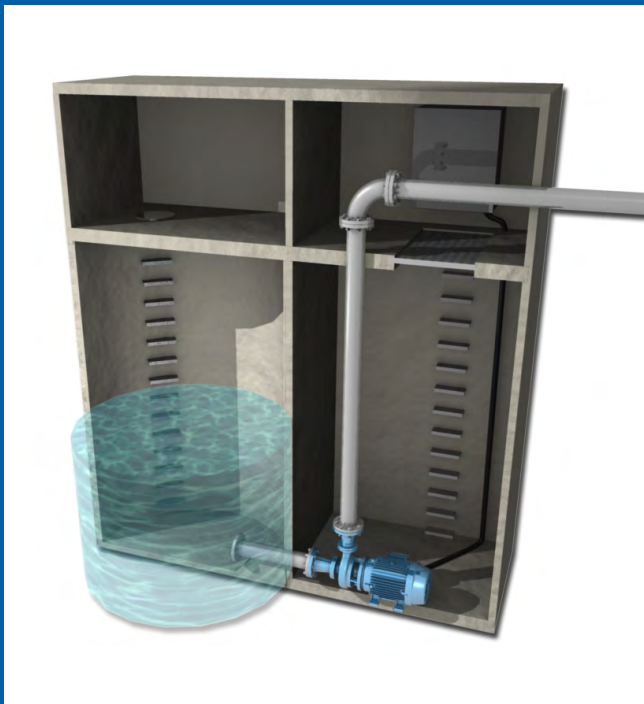
Figuur 1: Pomp opstelling met toeloop
